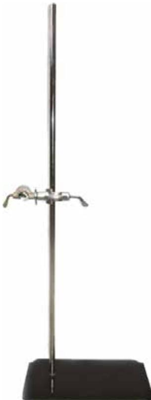
Soportes regulables para sujetar las termocuplas en la altura adecuada durante el proceso de calibración.
